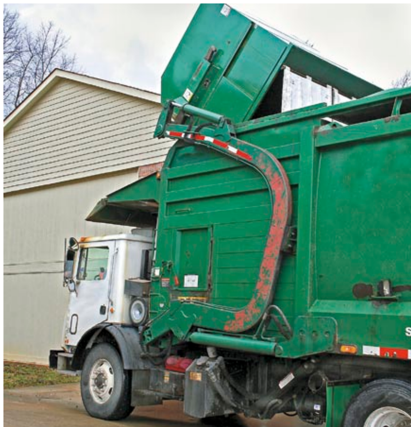
Śmieciarki z przednim załadunkiem najczęściej wykorzystuje się do obsługi klientów dostarczających odpady w stosunkowo dużych pojemnikach (tu: popularny „nosorożec” pod koniec cyklu rozładowywania) (3xDepositphotos).
