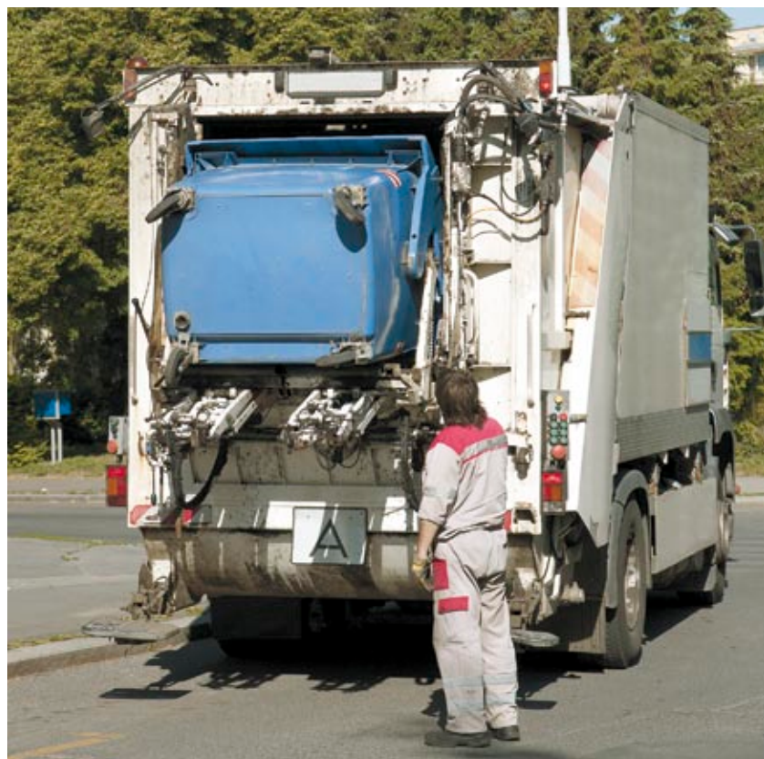
W przeciwieństwie do pojazdów z przednim i bocznym załadunkiem w tym wariantcie (załadunek tylny) większość pracy wykonuje załoga śmieciarki.
